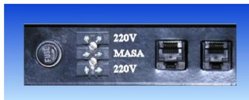
En el la parte superior del equipo se presenta una bornera para la conexión de 220VAC y una ficha RJ45 para los pulsadores de programación.
