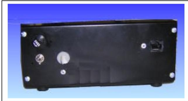
En la parte posterior se encuentra la entrada de 220VAC con toma de tierra y la ficha de salida RJ45 hembra que va hacia los tableros.
