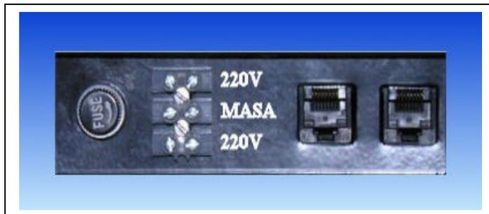
Los 220VAC se conectan entre extremos de la bornera y la tierra en el medio, esta conexión toma toda la estructura metálica para seguridad.
