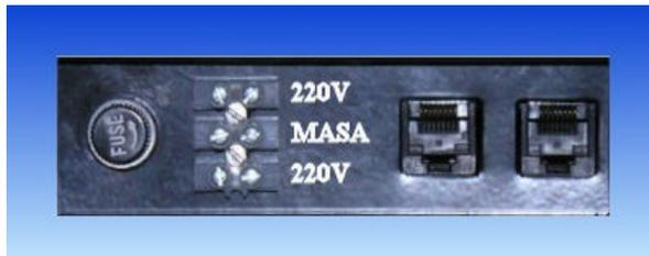
Los 220VAC se conectan entre extremos de la bornera y la tierra en el medio, esta conexión toma toda la estructura metálica para seguridad.
