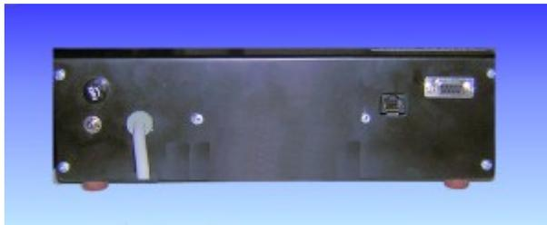
En la parte posterior de la consola se encuentran las conexiones: parte superior izquierda el FUSIBLE, la entrada de energía 220VAC y abajo la llave de encendido.
