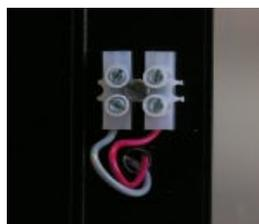
Esta salida presenta 12VCC en el momento de sonar la bocina, cuando termina el tiempo de posesion. Es una salida de Baja potencia: NO CONECTAR LUCES O CARGAS de potencia.
